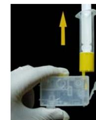
5. Потяните поршень шприца вверх до упора (вытягивая тем самым воздух из картриджа и создавая там разрежение) и отпустите его.
